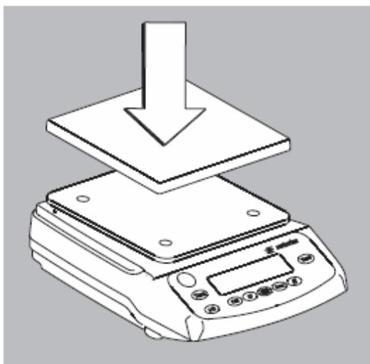
**⚠** 放置称盘时，调整放置位置，将橡胶地角准确的放入称盘支架的孔中。
